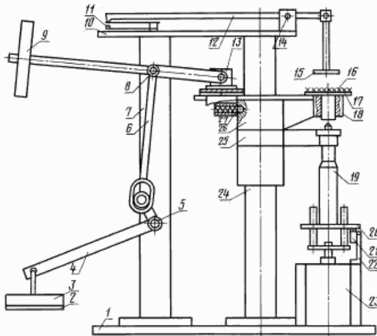
1 — основание; 2 — площадка для груза; 3 — груз; 4, 6 — рычаги; 5, 8, 14 — оси; 7 — стойка; 9 — противовес; 10, 13 — пластины; 11 — контакт; 12 — рычаг; 15 — шуп; 16 — элементарная проба; 17 — площадка для элементарных проб; 18 — втулка; 19 — микрометрический винт; 20 — диск; 21 — микропереключатель; 22, 25, 26 — кронштейны; 23 — электродвигатель; 24 — стойка; 27 — ступор.
