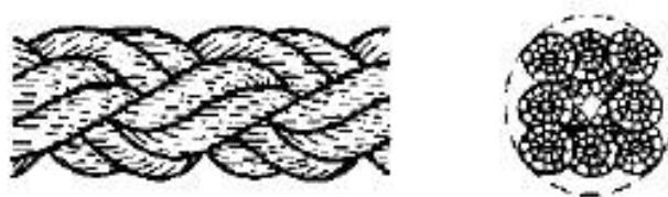
Рисунок 3 – Конфигурация 8-рядного плетеного каната (тип L)
