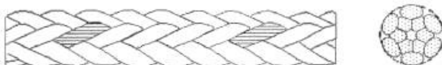
Рисунок 4 – Конфигурация 12-рядного плетеного каната (тип Т)
