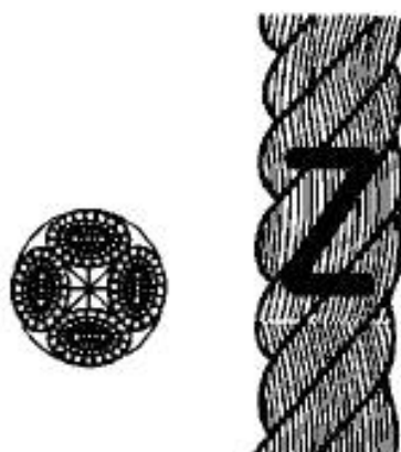
Рисунок 2 – Конфигурация 4-рядного (shroud-laid) каната (тип В)
