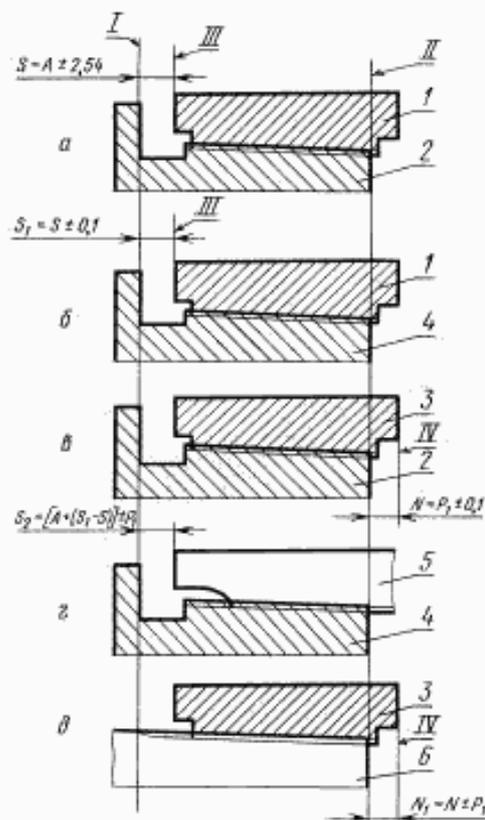
I — измерительная плоскость калибров-пробок (рабочего и контрольного), соответствующая концу сбега резьбы трубы; II — измерительная плоскость контрольного калибра-пробки, соответствующая торцу трубы; III — измерительная плоскость контрольного калибра-кольца; IV — измерительная плоскость рабочего калибра-кольца; I — контрольный калибр-кольцо; 2 — контрольный калибр-пробка; 3 — рабочий калибр-кольцо; 4 — рабочий калибр-пробка; 5 — муфта; 6 — труба.
