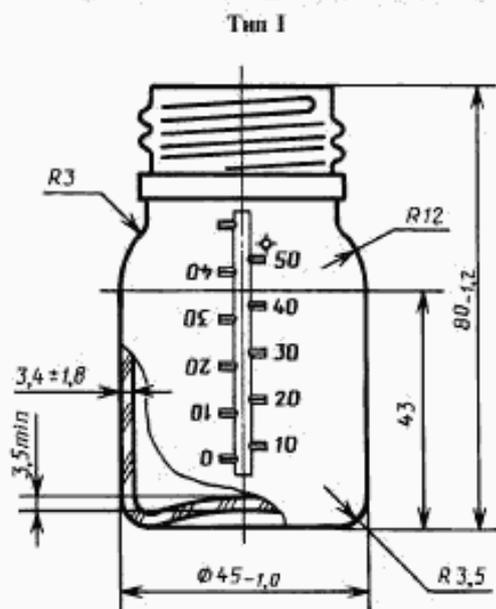
Условное обозначение бутылок должно содержать: обозначение типа бутылки, номинальную вместимость в см<sup>3</sup>, номер группы по обработке поверхности, марку медицинского стекла и обозначение настоящего стандарта.
