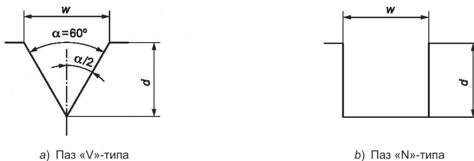
Рисунок 2 — Типы пазов «V» и «N»
