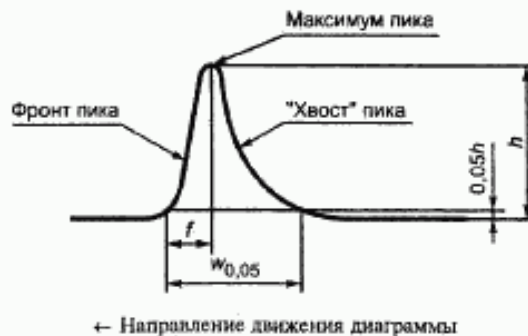
Рисунок А.2 — Асимметричный хроматографический пик
