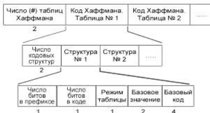
Рисунок 5 — Обзор структуры раздела таблиц Хаффмана
