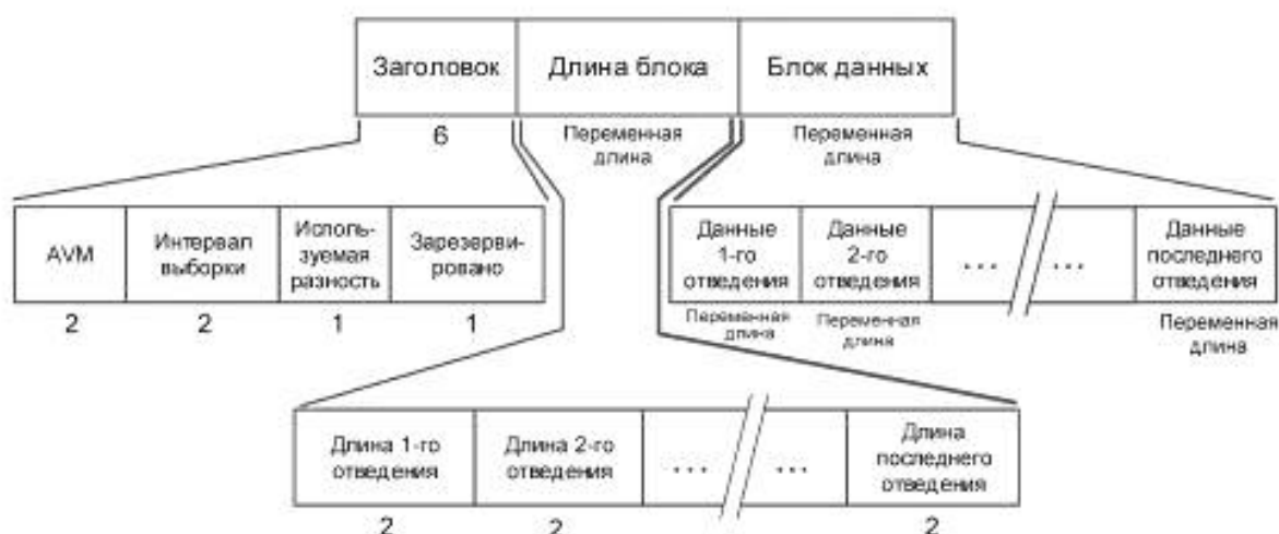
Рисунок 8 — Обзор структуры раздела закодированного эталонного цикла типа 0
