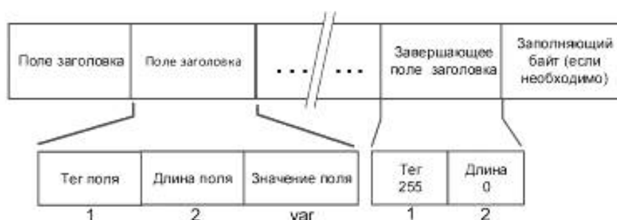
Рисунок 4 — Обзор части данных раздела «Заголовок»
