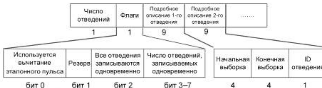
Рисунок 6 — Обзор части данных раздела определения отведения ЭКГ
