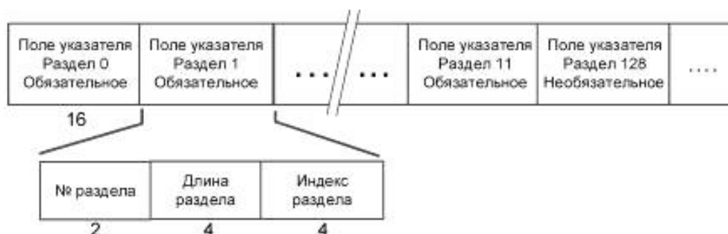
Рисунок 3 — Обзор структуры раздела указателя
