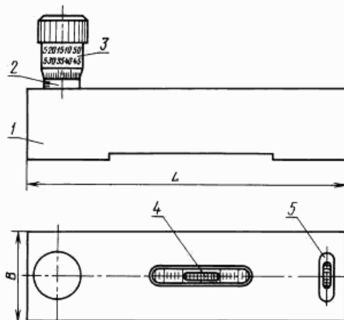
1 — основание; 2 — стелька; 3 — барабан; 4 — продольная ампула; 5 — поперечная ампула
