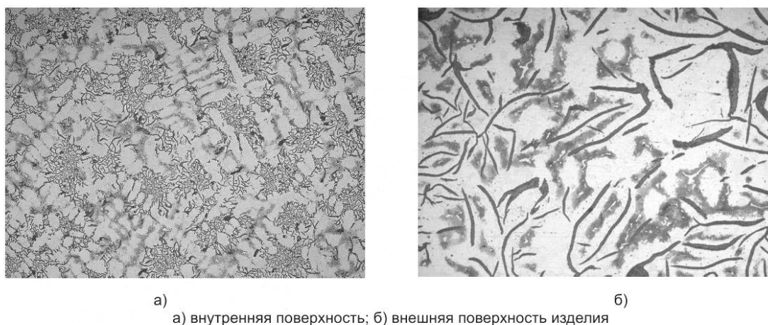
Рисунок 4 — Вид материала REG3 под микроскопом (увеличение в 100 раз)
