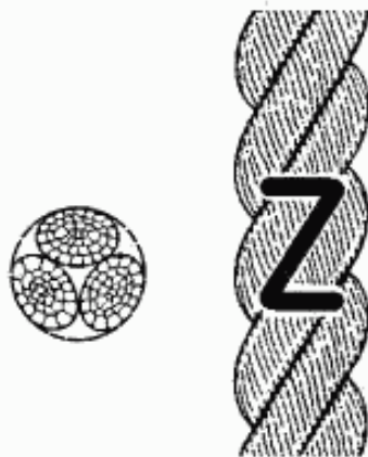
Рисунок 1 — Конфигурация 3-рядного крученого каната (тип А)
