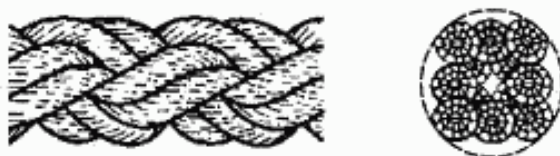
Рисунок 3 — Конфигурация 8-рядного плетеного каната (тип L)
