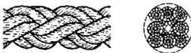
Рисунок 2 — Конфигурация 4-рядного крученого каната (тип В)
