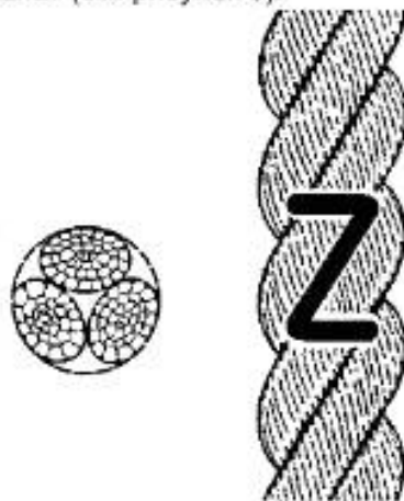
Рисунок 1 — Конфигурация 3-рядного крученого каната (тип А)
