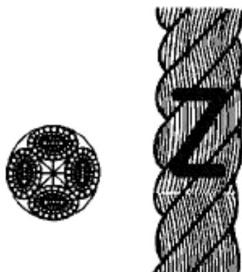
Рисунок 2 — Конфигурация 4-рядного крученого каната (тип В)
