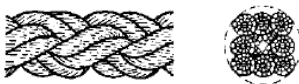
Рисунок 3 — Конфигурация 8-рядного плетеного каната (тип L)
