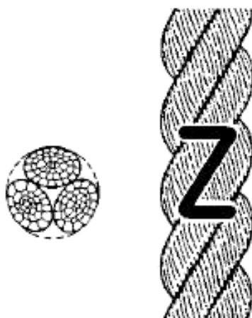
Рисунок 1 — Конфигурация 3-рядного крученого каната (тип А)
