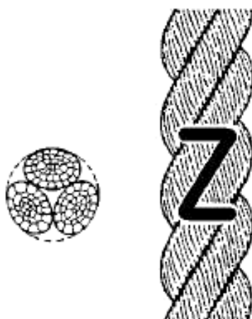
Рисунок 1- Конфигурация 3-рядного крученого каната (тип А)
