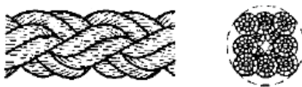
Рисунок 3-Конфигурация 8-рядного плетеного каната (тип L)
