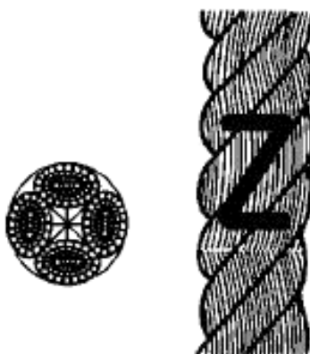
Рисунок 2- Конфигурация 4-рядного крученого каната (тип В)
