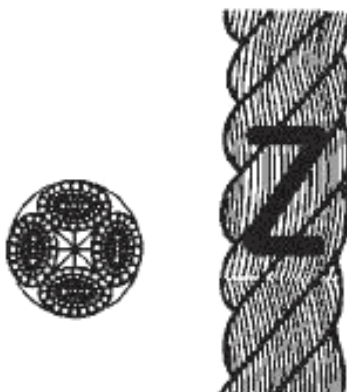
Рисунок 2 — Конфигурация 4-рядного крученого каната (тип В)
