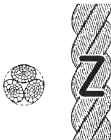
Рисунок 1 — Конфигурация 3-рядного крученого каната (тип А)
