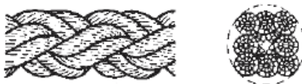
Рисунок 4 — Конфигурация 12-рядного плетеного каната (тип Т)
