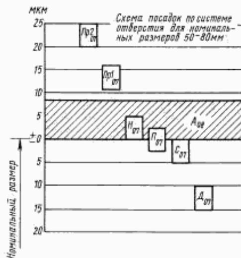
Система отверстия. Вали класса точности 08 в сочетании с основным отверстием класса точности 09
