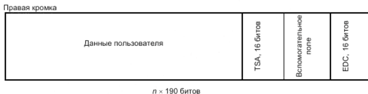
Рисунок 10 – Структура блока данных сектора (за исключением секторов типа 5)
