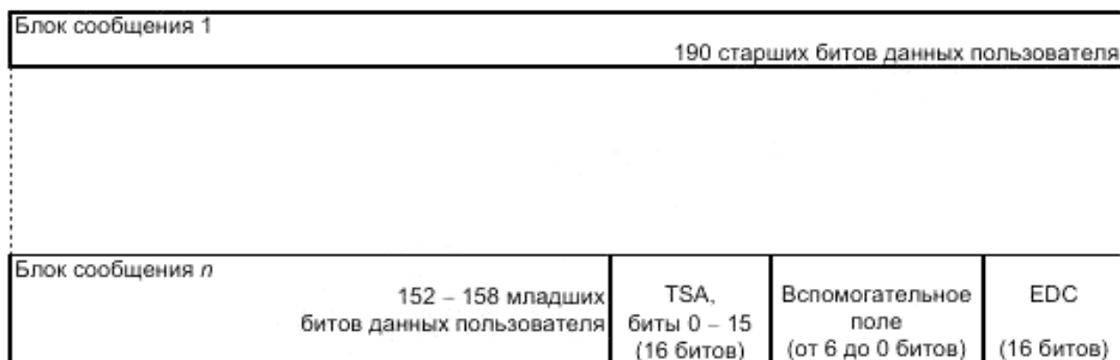
Рисунок 12 – Данные сектора до применения кода EDAC (для секторов всех типов, за исключением типа 5)
