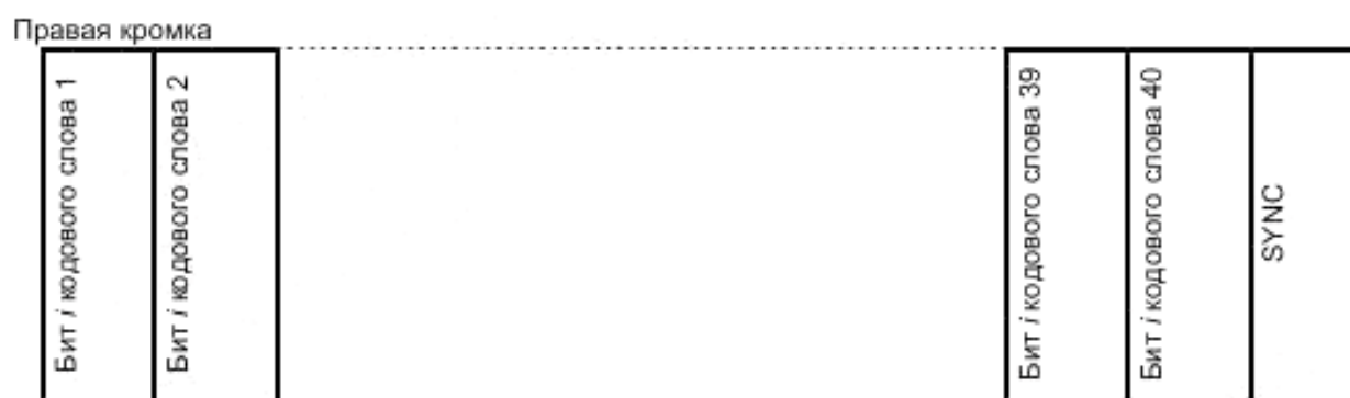
Рисунок 9 – Структура кадра номер i для секторов с максимальным перемежением
