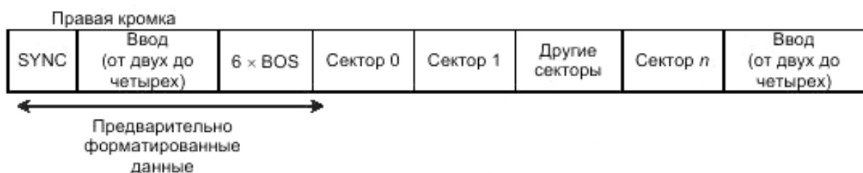
Рисунок 5 – Структура полной дорожки, секторы типов 0 – 5
