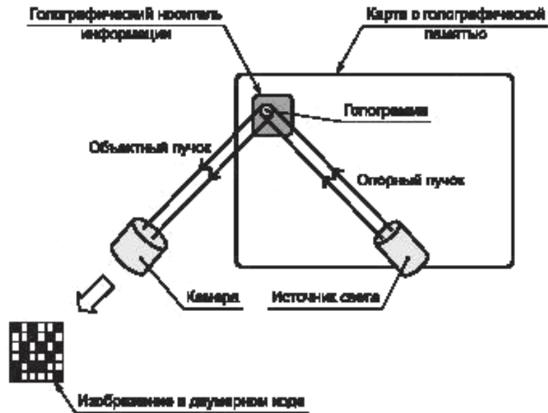
Рисунок А.2 — Схема считывания голограммы
