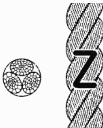
Рисунок 1 — Конфигурация 3-рядного крученого каната (тип А)
