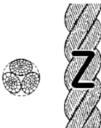
Рисунок 1- Конфигурация 3-рядного крученого каната (тип А)
