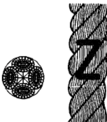
Рисунок 2- Конфигурация 4-рядного крученого каната (тип В)
