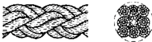
Рисунок 3- Конфигурация 8-рядного плетенного каната (тип L)
