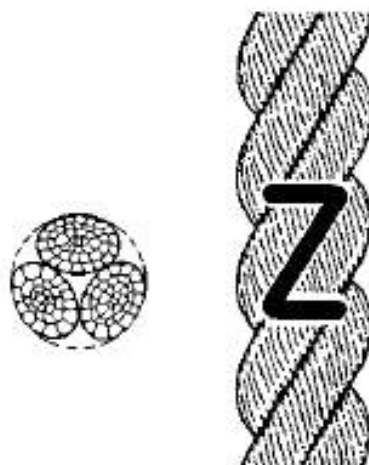
Рисунок 1- Конфигурация 3-рядного крученого каната (тип А)
