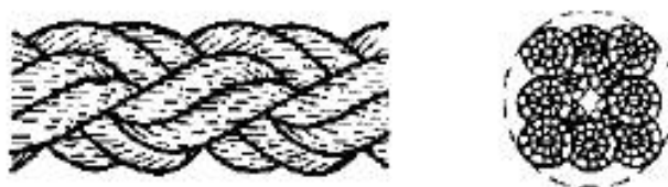
Рисунок 3- Конфигурация 8-рядного плетенного каната (тип L)
