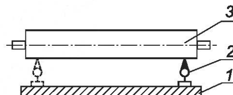
1 — опорная балка; 2 — средство измерений; 3 — подающий валец
