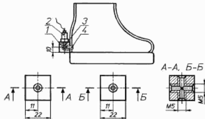
1 — кубик из дюралюминия (марки Д16Т по ГОСТ 21631—76); 2 — вибропреобразователь; 3 — шайба крепления вибропреобразователя к кубику; 4 — винт с потайной головкой для крепления кубика к ботинку
