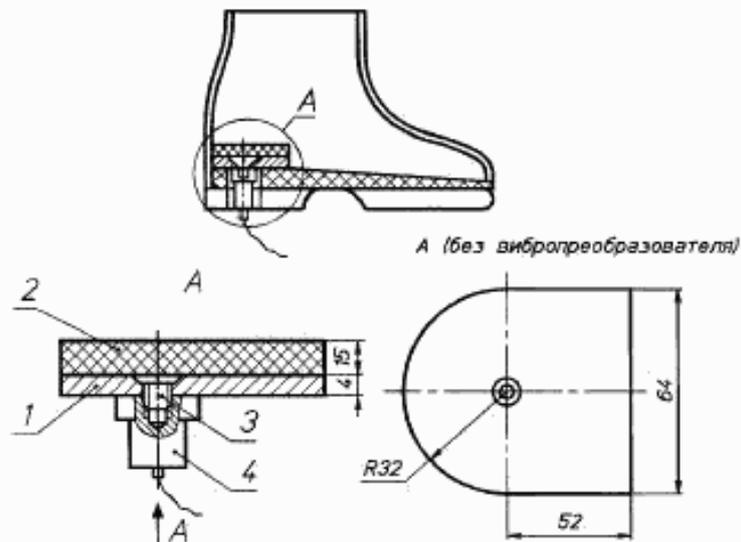
1 — дюралюминиевая пластина (марки Д16Т по ГОСТ 21631—76); 2 — резиновая прокладка; 3 — винт; 4 — вибропреобразователь
