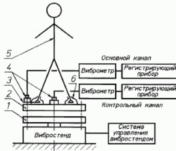
1 — стол вибростенда; 2 — платформа; 3 — измерительное приспособление (подъёмник); 4 — измерительный вибропреобразователь; 5 — испытатель; 6 — испытываемая обувь
