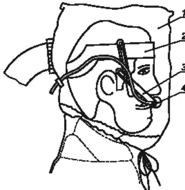
1 — испытуемый капюшон; 2 — оголовье; 3 — регулируемый пластмассовый кронштейн; 4 — пробоотборник
