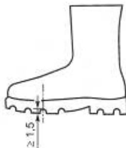
Рисунок В.1 — Трещины на подошве
