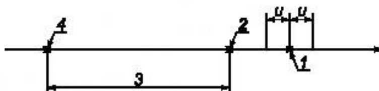
1 — результат измерения; 2 — верхнее предельное значение параметра; 3 — интервал допустимых значений параметра; 4 — нижнее предельное значение параметра
