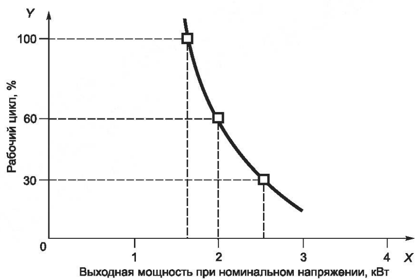
Рисунок В.1 — Пример рабочего цикла относительно выходной мощности при номинальном напряжении
