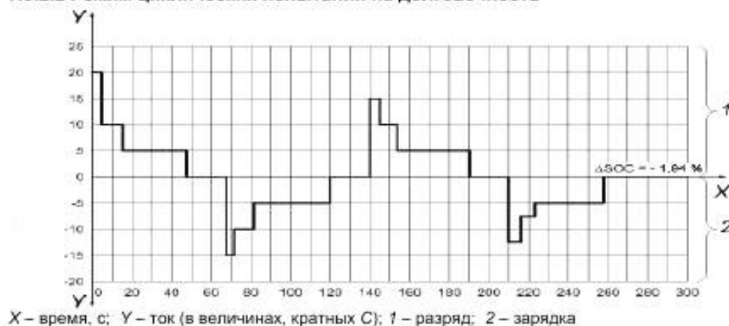
Рисунок 7 — Изменение тока по времени в режиме постепенного разряда для циклического испытания на долговечность
