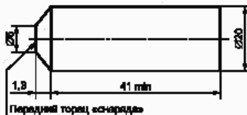
Рисунок А.1 — Перемещаемый «снаряд» при испытании на удар
