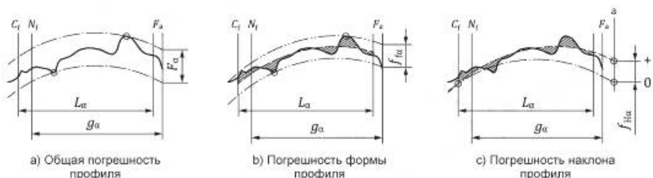
Рисунок 5 — Погрешности профиля с модифицированным углом зацепления
