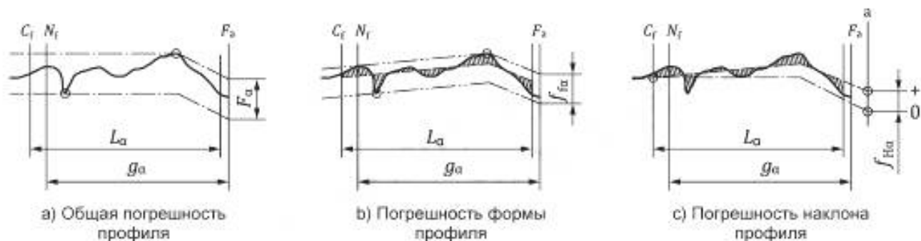
Рисунок 7 — Погрешности профиля с модифицированной головкой
