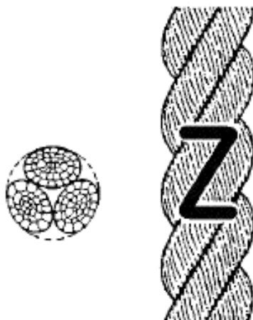
Рисунок 1- Конфигурация 3-рядного крученого каната (тип А)
