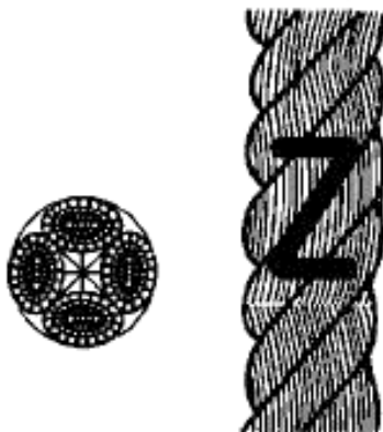
Рисунок 2 - Конфигурация 4-рядного крученого каната (тип В)
