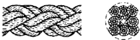
Рисунок 3- Конфигурация 8-рядного плетеного каната (тип L)
