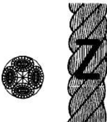
Рисунок 2 - Конфигурация 4-рядного крученого каната (тип В)
