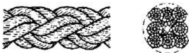
Рисунок 3- Конфигурация 8-рядного плетеного каната (тип L)
