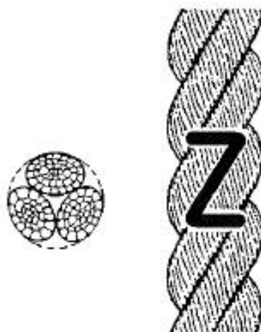
Рисунок 1- Конфигурация 3-рядного крученого каната (тип А)
