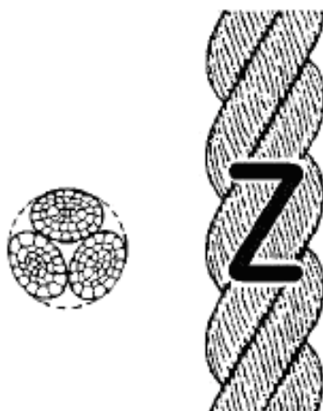
Рисунок 1 — Конфигурация 3-рядного крученого каната (тип А)
