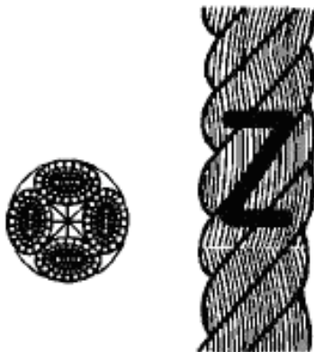
Рисунок 2 — Конфигурация 4-рядного крученого каната (тип В)
