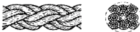
Рисунок 3 — Конфигурация 8-рядного плетеного каната (тип L)
