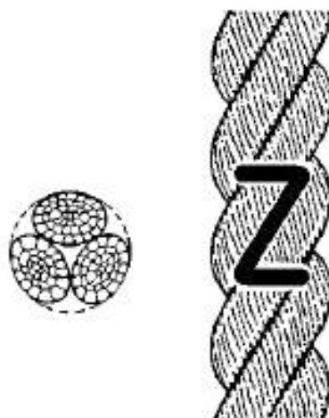
Рисунок 1 — Конфигурация 3-рядного крученного каната (тип А)
