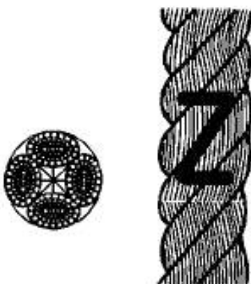
Рисунок 2 — Конфигурация 4-рядного крученного каната (тип В)
