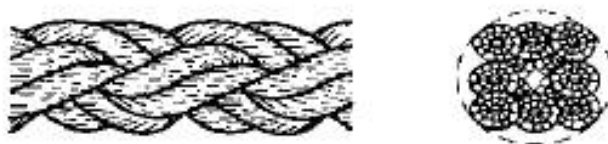
Рисунок 3 — Конфигурация 8-рядного плетеного каната (тип L)
