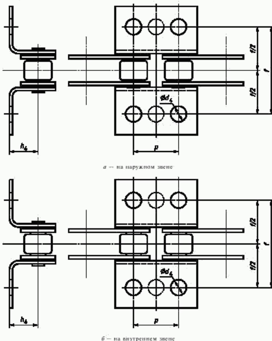
**Примечание** — Полки звеньев типа К2 имеют по два монтажных отверстия, а типа К1 при таких же размерах по одному отверстию, расположенному в середине полки, как показано пунктиром (см. А.3.2)
