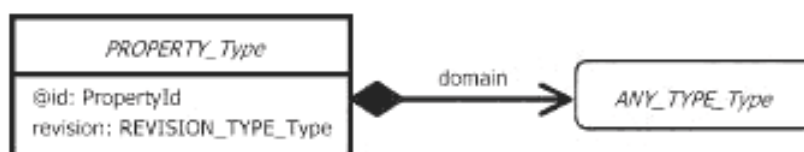
Рисунок 7 — UML-представление элемента XML-языка комплексного XML-типа данных
