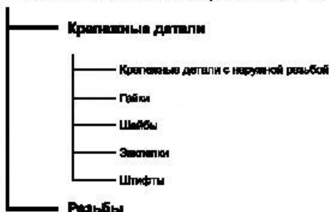
Рисунок 1 — Класс вид крепежных деталей в общей иерархии расположен ниже класса крепежные детали
