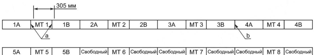
а) Схема отбора исходной заготовки (вариант 1)
