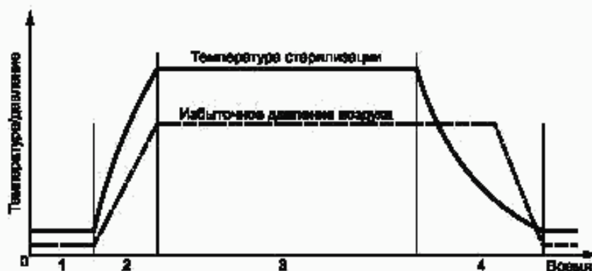
Рисунок В.5 — Пример цикла стерилизации погружением в воду
