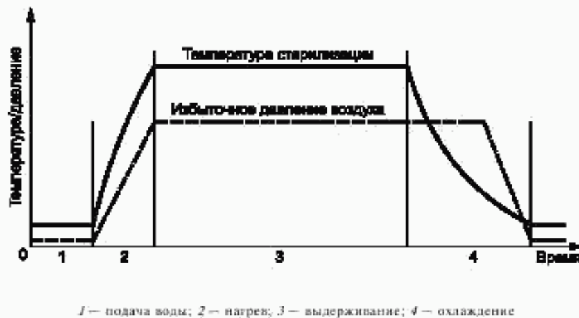
Рисунок В.4 — Пример цикла стерилизации с распылением воды
