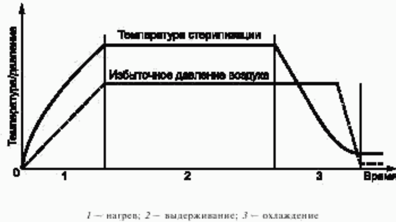
Рисунок В.3 — Пример цикла стерилизации паровоздушной смесью
