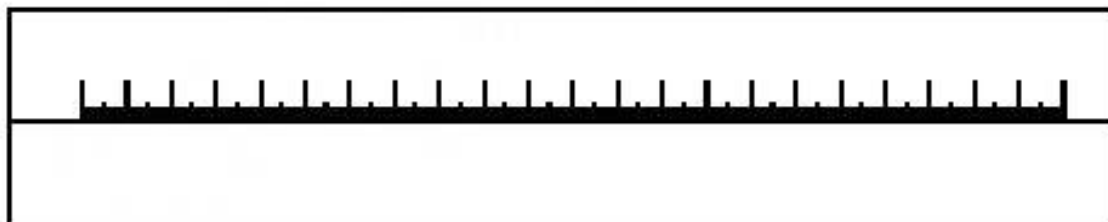
Рисунок 1 — Центральная прозрачная градуированная шкала, перемещаемая между направляющими
