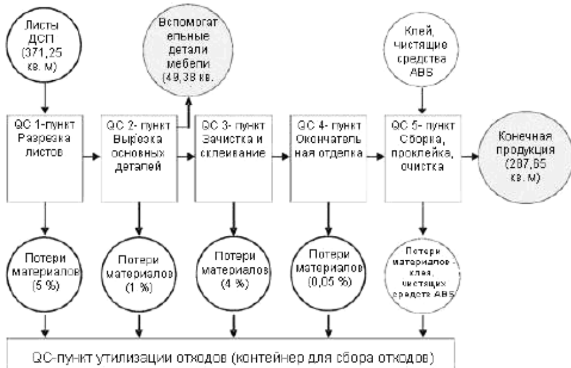
Рисунок С.4 — Модель материальных потоков в основном целевом процессе
