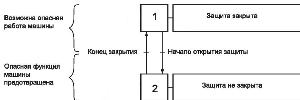
Рисунок 3 — Функциональная схема блокировочных устройств без защитной блокировки
