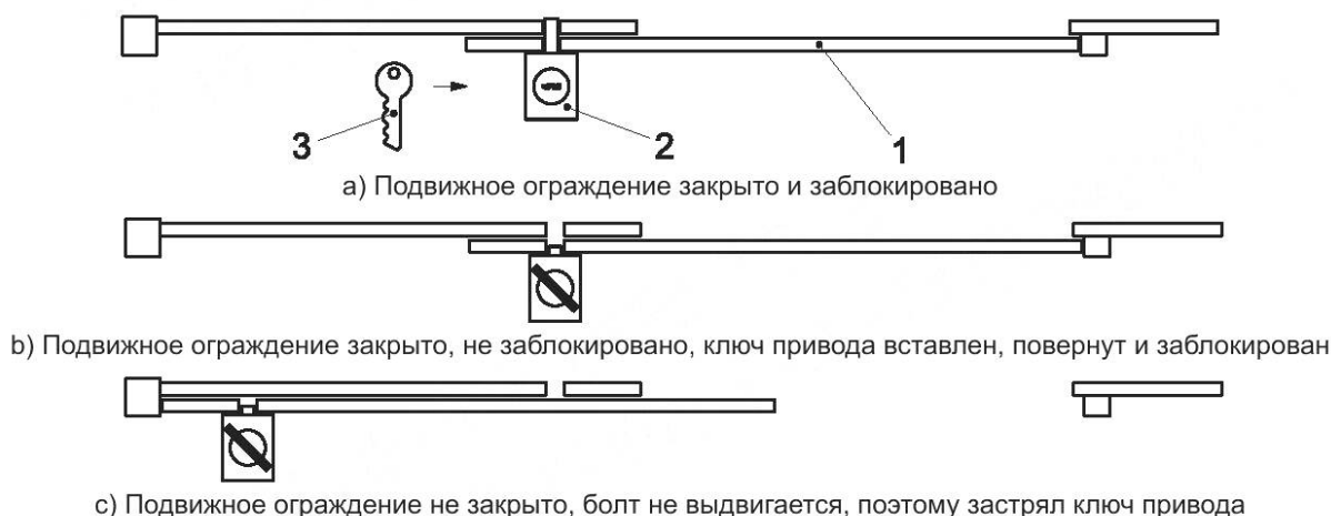
Рисунок В.3 — Принцип блокировки заблокированного ключа — Шаг 1
