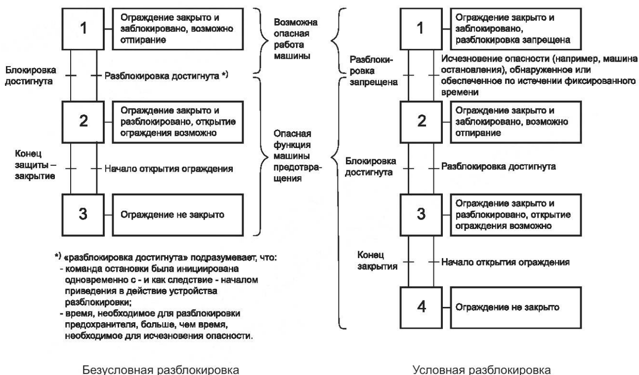
Рисунок 4 — Функциональные схемы блокировочных устройств с защитной блокировкой
