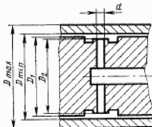
$D_{\max}$  — максимальный предельный размер отверстия;  $D_{\min}$  — минимальный предельный размер отверстия
