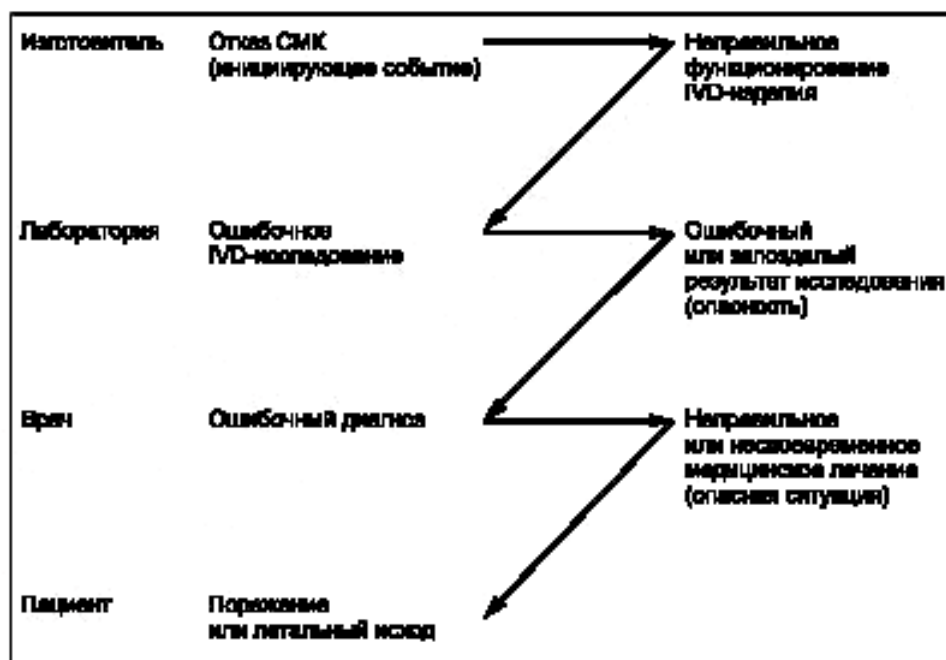
Рисунок Н.1 — Модель рисков применения медицинского изделия для диагностики in vitro в лабораторных условиях
