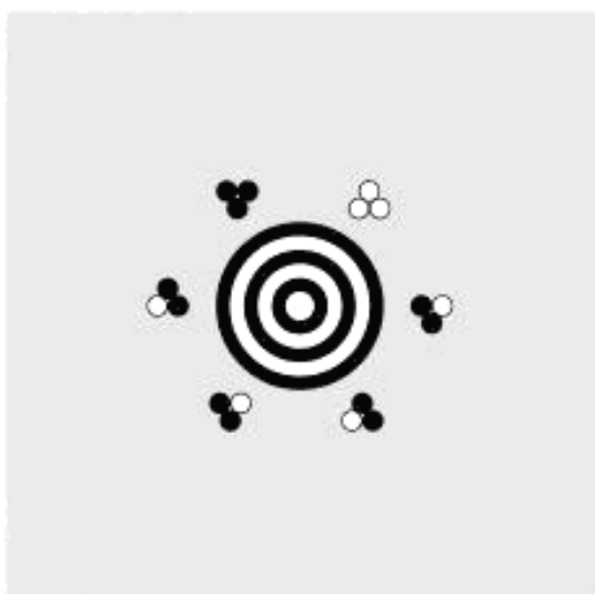
Рисунок А.1 — Фиксированные шаблоны в символе MaxiCode
