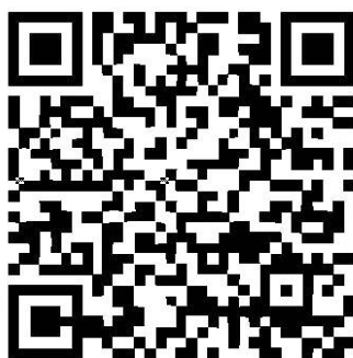
Рисунок А.4 — Символ QR Code с параметром «повреждение фиксированных шаблонов»
