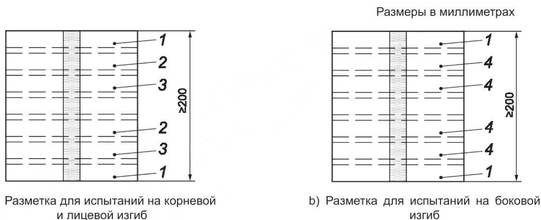
Рисунок 5 — Тип и место расположения заготовок для испытаний на изгиб листов
