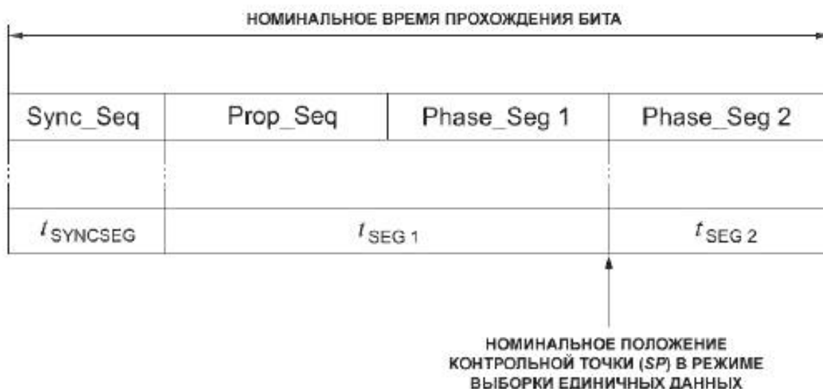
Рисунок 8 – Разбиение времени прохождения бита шины CAN
