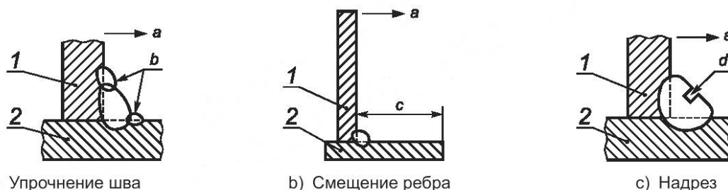
Рисунок 3 — Методы, способствующие разрушению по толщине углового шва
