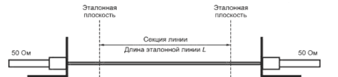
Рисунок 24д) — Конфигурация при калибровочном измерении «Линия»
