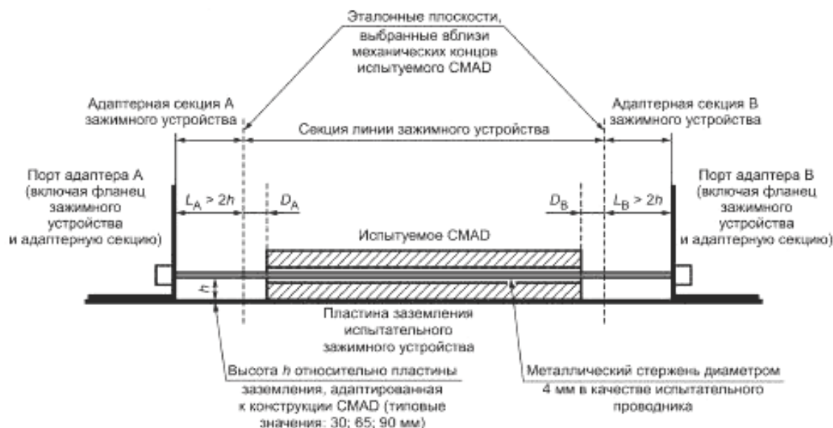
Рисунок 23 — Определение эталонных плоскостей внутри испытательного фиксирующего устройства
