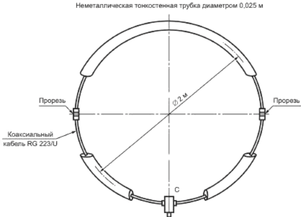
Рисунок С.2 — Большая рамочная антенна с двумя противоположными прорезями, расположенными симметрично относительно токосъёмника С
