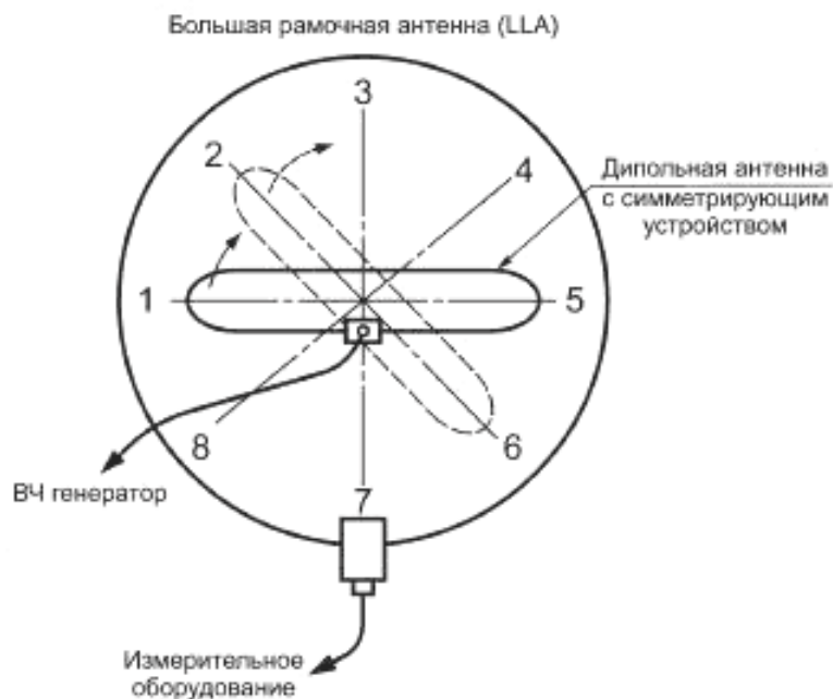
Рисунок С.7 — Восемь положений установки диполя при валидации большой рамочной антенны
