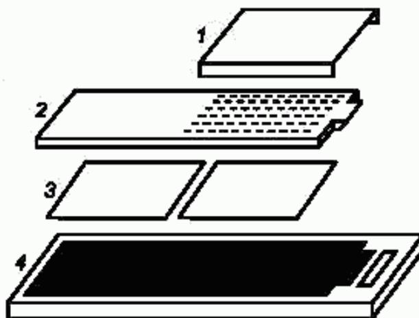
1 — скользящая крышка; 2 — диффузионный экран; 3 — фильтры пропитанные ДНФГ; 4 — корпус пробоотборного устройства
